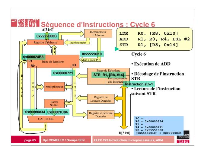
Le ADD est maintenant exécuté. Le registre R4 qui est sur le bus B est décalé de 2 bits par le barrelshifter
