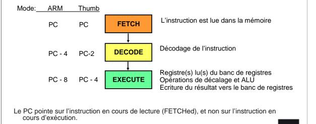
Les instructions sont "pipelinées" en 3 cycles d'horloge : FETCH, DECODE et EXECUTE. Ainsi le concept RISC (1 instruction par cycle) est respecté.
