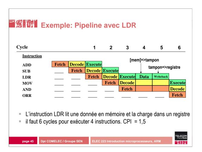
Le pipeline est rompu lors d'un LOAD ou STORE. Dans cet exemple le LDR (LOAD Register) nécessité d'aller chercher la donnée dans la phase d'exécution. 1 cycle (cycle 4) est nécessaire pour lire la mémoire et mettre la donnée dan un registre tampon. Un autre cycle (cycle 5) sert à transférer la donnée du registre tampon vers le banc de registre.
