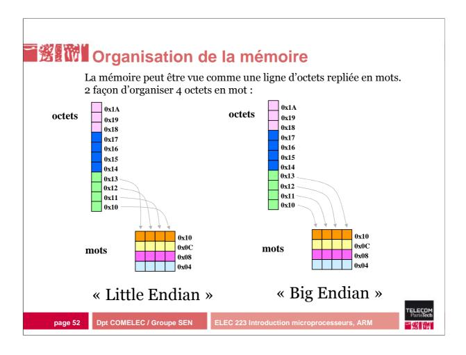
Au sein d'un mot et d'un demi-mot, il y 2 façon d'adresser les octets. Ces 2 types d'adressage existent depuis les premiers microprocesseurs 16 bits où Intel (8086) et Motorola (68000) avaient choisi chacun un type différent.
