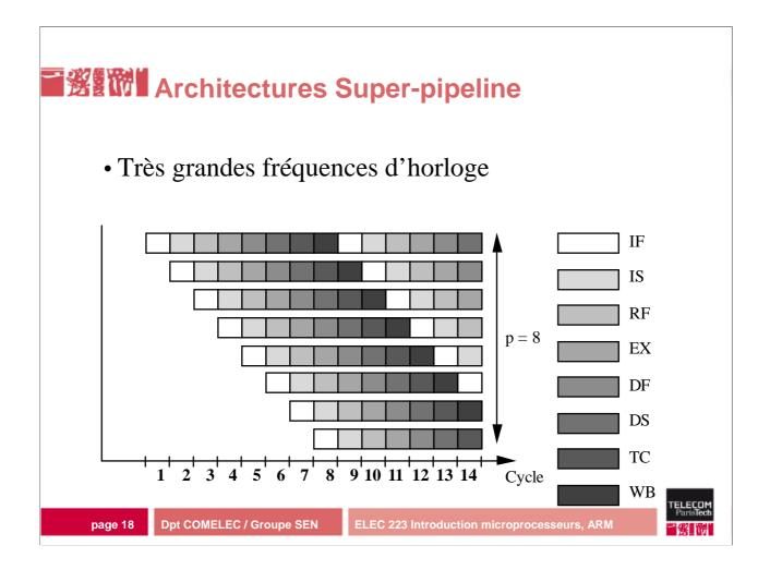
Certains processeurs comme le pentium ont de nombreux niveaux de pipeline (>20). Cette technique "superpipeline" permet de diminuer les temps critiques et donc d'augmenter la fréquence de fonctionnement.
