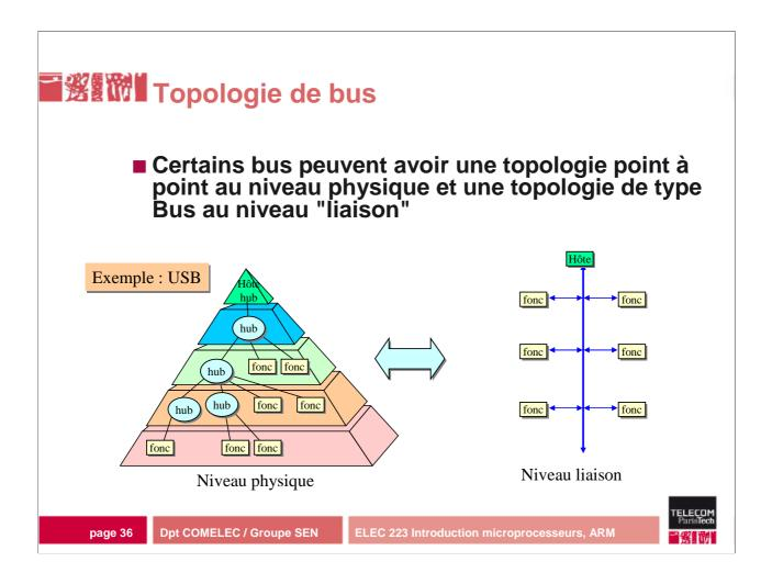
Le bus USB a une topologie virtuelle de bus au niveau "liaison" de la communication mais sa couche physique est composée de liaisons point à point. Il n'existe qu'un seul maître qui est le processeur.
