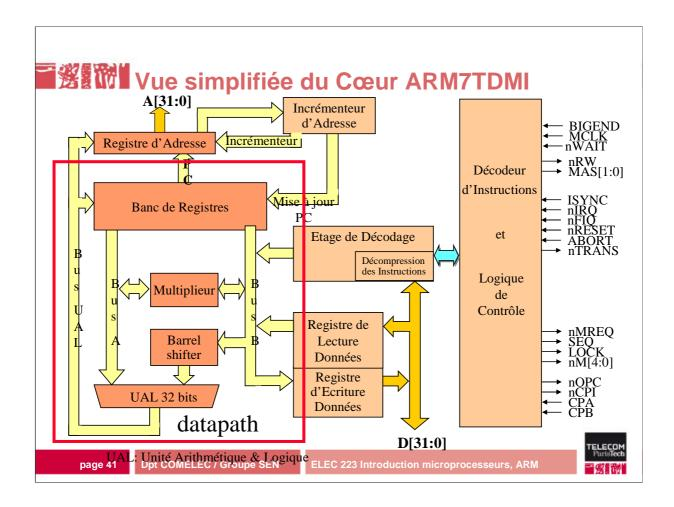
L'architecture de l'ARM 7 est Von Neuman, c'est-à-dire qu'il n'y a qu'un bus pour véhiculer les instructions et les données. L'ARM dispose de 16 registres visibles sur lesquels les opérations sont effectuées. Les instructions LOAD/STORE servent respectivement à précharger/stocker les résultats de/vers la mémoire.
