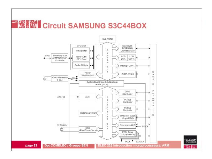
Le circuits SAMSUNG S3C44BOX dispose de nombreuses interfaces utiles à un système embarqué. C'est sur ce processeur que les TDs vont s'appuyer.
