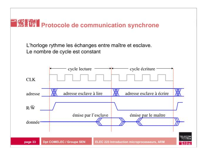
Le protocole utilisé sur un bus est celui qu'on retrouve dans tous les systèmes de communication. Il est soit direct , c'est à dire sans préoccupation d'acceptation de l'élément adressé, ou **asynchrone** c'est-à-dire avec un échange "poignée de main" ou "Handshake" pour s'assurer de la fiabilité de la transaction.
