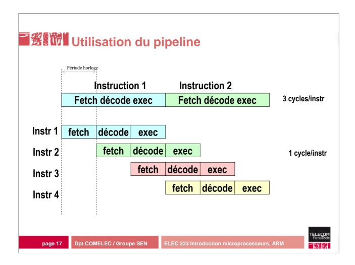
Le pipeline d'instruction permet d'exécuter une nouvelle instruction à chaque cycle d'horloge.
