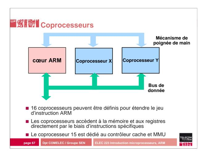
Il est possible d'adjoindre des accélérateurs de calcul ou "coprocesseur" au processeur ARM. Les coprocesseur sont pilotés par l'ARM via une liaison spécifique. Lorsqu'une instruction coprocesseur est décodée, l'ARM déclenche le coprocesseur adressé qui va lire ou écrire à la volée les données transitant sur le bus. Si aucun coprocesseur n'est détecté, le processeur rentre en mode "undefined instruction" qui lui permet d'effectuer le calcul sans coprocesseur donc plus lentement.
