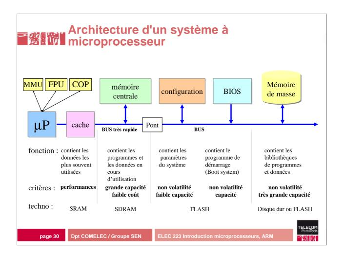
Un système électronique peut utiliser différentes variétés de mémoires en fonction des besoins. Par exemple dans un ordinateur la SRAM rapide est utilisée comme cache et est gérée par un contrôleur de cache. La DRAM, de taille plus importante, est utilisée comme mémoire de programmes, la mémoire FLASH contient le BIOS pour le démarrage. La mémoire de masse utilise des technologies magnétiques , optiques ou électroniques avec l'augmentation en capacité des mémoires FLASH de type NAND FLASH
