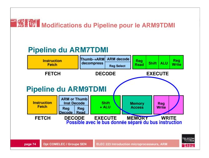
Dans l'ARM9, les 2 phases supplémentaire d'accès mémoire MEMORY et de transfert avec le registre tampon WRITE permettent d'effectuer des LOAD/STORE sans rompre le pipeline. Les 2 cycle perdus de l'ARM7 lors des LOAD/STORE ont maintenant disparus.
