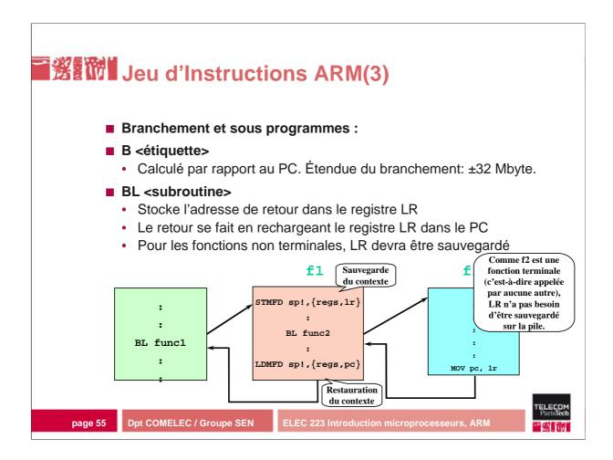
Le LR doit lui-même être empilé lorsqu'il y a des appels sous-programmes imbriqués. Remarquez l'instruction de dépilage à la fin du sous-programme f1 où un LOAD multiple permet de recharger le PC avec la valeur de LR.
