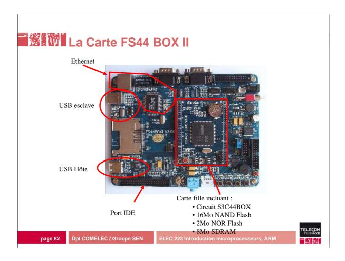
La carte dispose d'un processeur SAMSUNG S3C44BOX. Le système est articulé autour d'un noyau uClinux.
