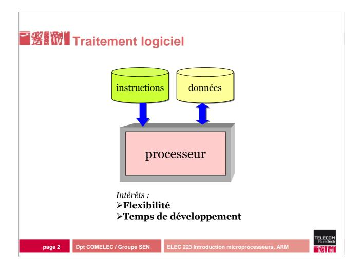
Les 2 types de traitement reposent avant tout sur des technologies **électroniques**. Un traitement **logiciel** utilise un processeur alors qu'un traitement **matériel** utilise un contrôleur spécialisé.
