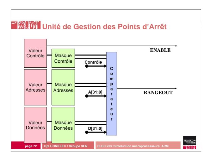
Par le biais du JTAG, le concepteur peut accéder à la programmation de l'émulateur embarqué. Ceci consiste à définir la condition du point d'arrêt sur les bus de l'ARM. L'émulateur consiste en une série de comparateur qui active le signal RANGEOUT qui va activé le point d'arrêt en quand la condition est remplie.
