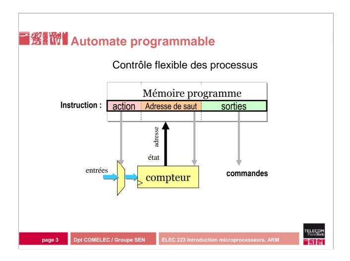
L'automate programmable ou le séquenceur est une machine à états de Moore générique dont le registre d'état est un compteur qui peut être incrémenté ou chargé par une nouvelle valeur. Ce compteur pointe dans une mémoire sur une « instruction » qui contient l'action à effectuer (+1 ou saut) en fonction des entrées et l'adresse de saut dans le cas d'un saut. L'instruction a également un champ pour les sorties servant à piloter des actionneurs extérieurs.
