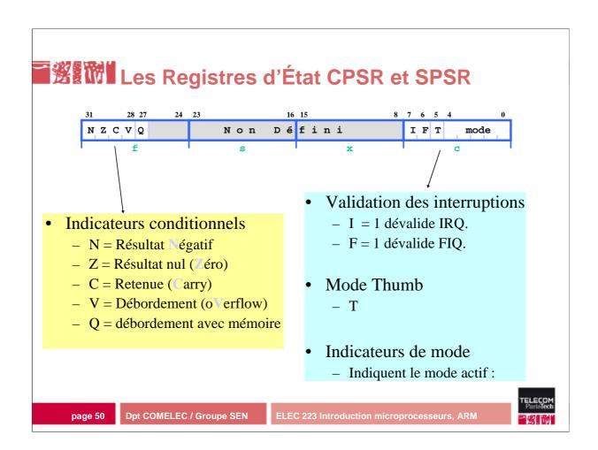
Les bits de fort poids représentent les indicateurs de l'UAL. Les bits 6 et 7 sont des bits de contrôle pour masquer les interruptions. Le bit 5 permet de passer en mode Thumb et les 5 bits de faible poids indiquent le mode.
